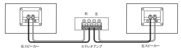
もし接続を間違えますと、音の定位及び音質等が損なわれます。
